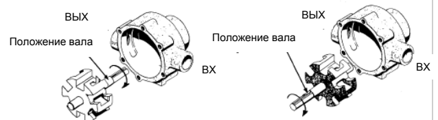
Рис.7 Изменение стандартного вращения против часовой стрелки на вращение по часовой стрелке
